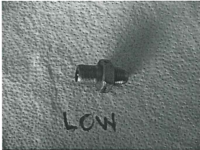
Fotografía No. 5. Detector inferior de partículas en el aceite del motor
